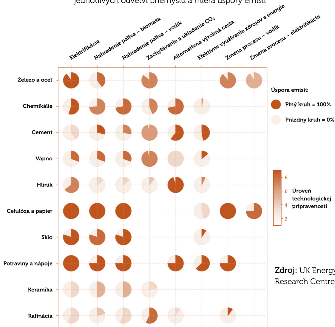
Graf č. 10: Miera pripravenosti technológií (TRL) pre dekarbonizáciu jednotlivých odvetví priemyslu a miera úspory emisií 98
